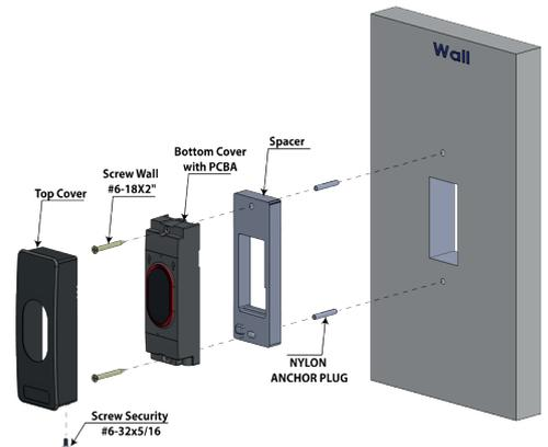
Le modèle étroit (XS), représenté ci-dessus, peut être installé avec entretoise (réf. SOC05HR1000-N). Cette entretoise, fixée au mur par 2 vis, est nécessaire au fonctionnement du dispositif infrarouge anti-arachement et elle facilite l'installation des câbles et connecteurs.
