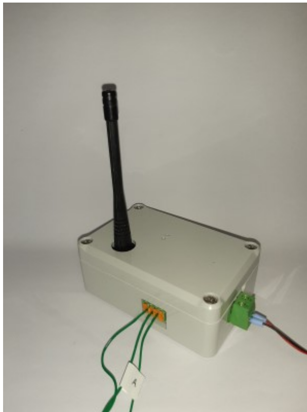
Figure 1.1. Hub radio Simons Voss avec vue sur la connexion de données (3 fils verts) et la connexion d'alimentation (fils noir et rouge)
